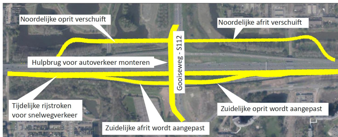
Afbeelding: de kruising A9 – Gooiseweg wordt op een aantal punten aangepast.
