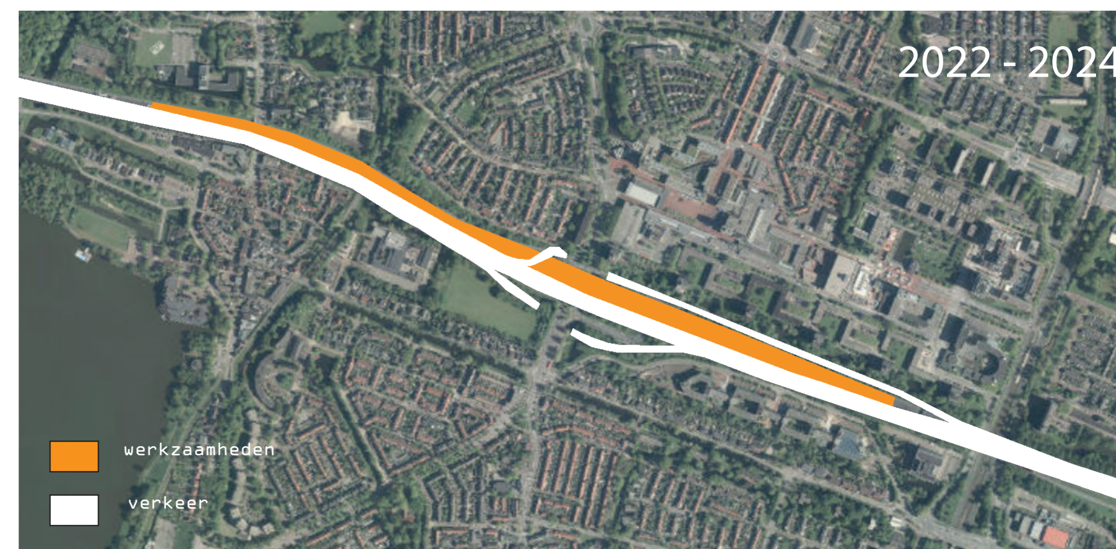
Het verkeer rijdt over de zuidzijde, noordzijde wordt gerealiseerd
