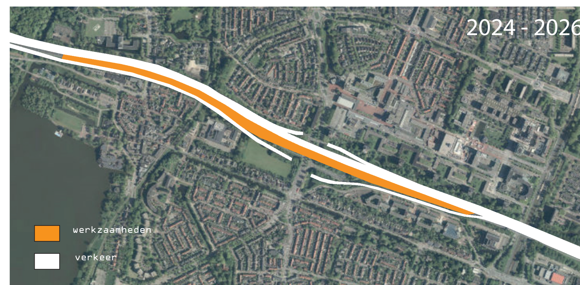
Het verkeer rijdt over de noordzijde, zuidzijde wordt gerealiseerd
